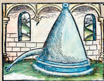
Ранні перегінні куби: Методи дистиляції з використанням конструкцій, що їх називали «два пелікани» (угорі) і «капельшок» (унизу), з відомої книжки Бруншвіга.
